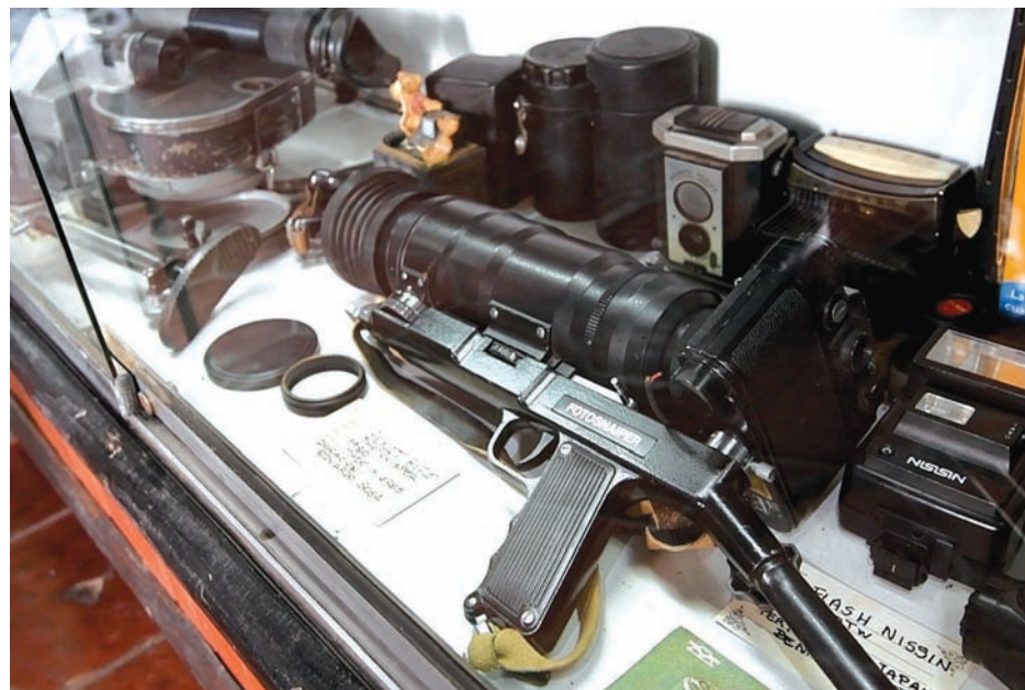
FOTOSNAIPER. Fabricado en la URSS, es una cámara montada sobre un chasis con culata, empuñadura y gatillo, diseñada para la fotografía de naturaleza, deportes y vigilancia militar.
