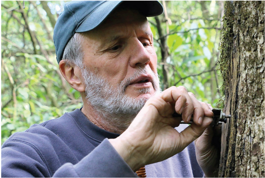
SENSORES. Ricardo Villalba verificando el correcto funcionamiento de un dendrómetro (instrumento de precisión diseñado para medir el crecimiento y los cambios de diámetro de árboles y arbustos).
